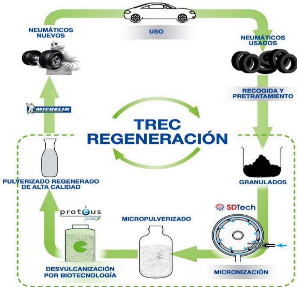
Figura 25 – Ejemplo de Recuperación de residuos de Neumáticos
